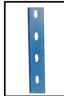
b) Vigas para miniracks: Las vigas serán en "Z" (doble C soldada) para miniracks de peralte de 3.5" serán fabricadas en plancha de acero de 2.0 mm de espesor, que irán enganchadas en los postes a través de **AGARRES de TRES (03) UÑAS** fabricadas en plancha de acero de 2.0 mm de espesor y aseguradas.
