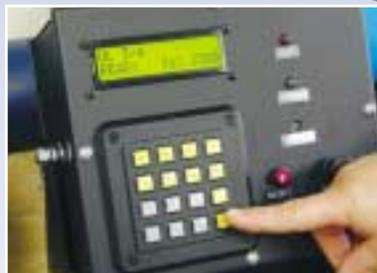
Introduzca el tipo y ancho de la abrazadera, así como el tipo de acero. Inserte la cola de la abrazadera y presione el pedal de pie. Cuando se alcanza la tensión programada, el corte y la expulsión de la cola son automáticos.
