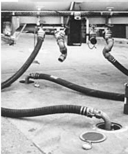
Aplicación en camión de transporte, con mangueras para cargar y descargar productos.
