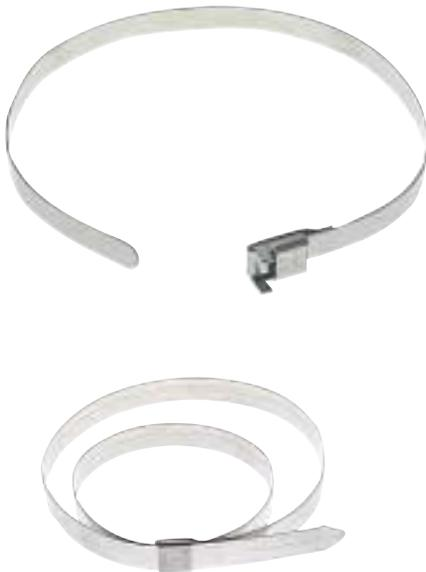
Las Abrazaderas de Extremo Abierto en Acero Inoxidable Austenítico y clip de Extremo Abierto se tensionan y después se cierran con un golpe de mazo o martillo. Utilice las herramientas Center Punch de BAND-IT.
