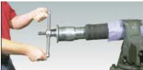
Ensamble la manija, el rodamiento, el maneral, la manga o base del dispositivo, coloque el niple para manguera en el mandril, utilice tenazas de latón en un tornillo o envuelva la manguera con un trapo para proteger la cubierta de la manguera, inserte el mandril en la manguera como se muestra, apriete el tornillo firmemente en la parte moleteada del mandril y dé vuelta a la manija para introducir el niple en la manguera.
