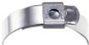
La Abrazadera Universal es una abrazadera Smooth I.D. (de diámetro interior uniforme) de un lazo, que puede ser sujeta con una terminación Tie-Lok o Ultra-Lok. Use la herramienta A920 o la IT1000 para la Tie-Lok y para la Ultra Lok, la herramienta A940 o la IT3000.
