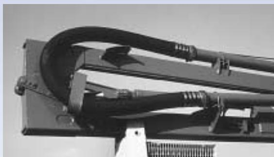
Aplicación de sujeción de manguera en bomba móvil para concreto, montada en camión con brazo aéreo para dirigir el fluido de concreto.
