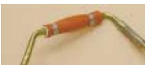
Líneas de combustible son protegidas del calor con mangas sujetadas con abrazaderas universales BAND-IT.
