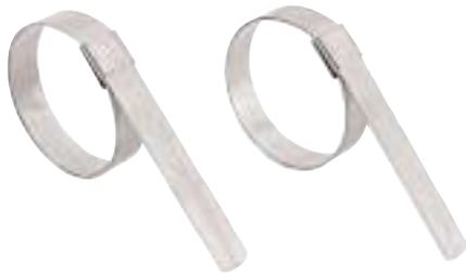
Las Abrazaderas BAND-ITCenter Punch se cierran con un punzón cónico estándar, proporcionando un fuerte y poderoso seguro para una sujeción confiable. Las Abrazaderas Center Punch, tanto en acero inoxidable 201 y en acero al carbón galvanizado, están fabricadas con hebillas en acero inoxidable 201 para proporcionar una máxima fuerza de cierre.
