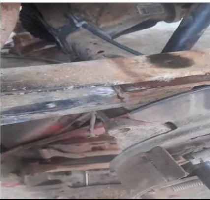
3- Cambio de hoja de muelle roto. Lado posterior izquierdo.
