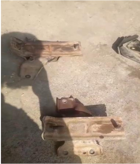
6- Montaje y desmontaje del soporte de motor 02 und. Se encuentran desgastadas, el motor ya q tiene una inclinación y choca con el chasis dañando el sistema eléctrico y convertidor de aire.
