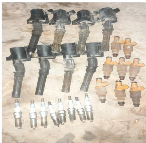
4- Extracción y cambio de bujías, inyectores y bobinas.(se encontraron bobinas e inyectores quemadas con ausencia de cambio más de 4 años)
