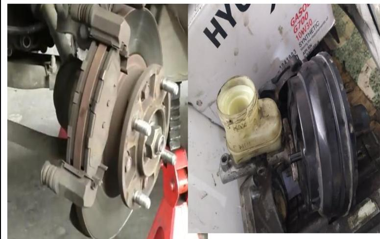
5- Mantenimiento del sistema de freno y reparación de Master.
