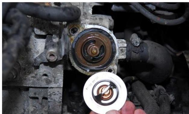
Cambio de termostato, refrigerante y perno
