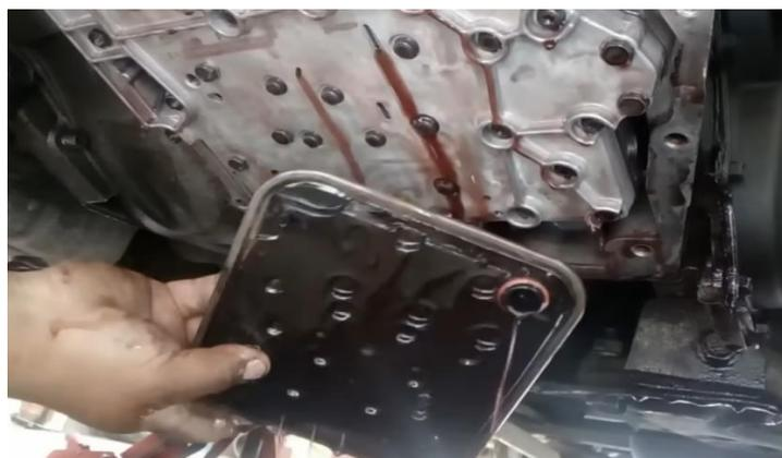
6- Mantenimiento de caja hidráulica y corona, Falta aceite.
