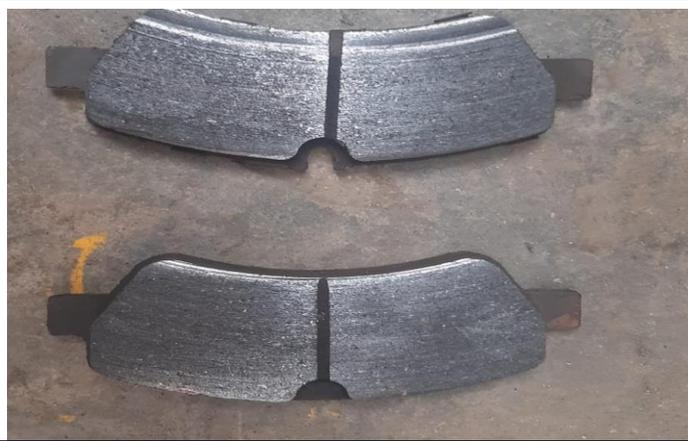
4- Pastillas posteriores y zapatas vencidas ya se aprecia el choque con fierro y Pastillas delanteras gastadas.
