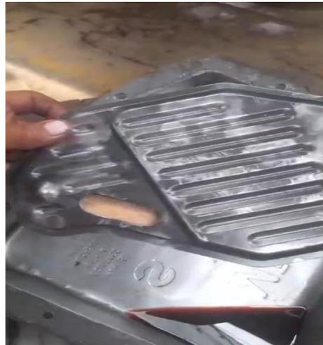
6- Mantenimiento de caja hidráulica y corona, Falta aceite y presencia de limañas en el filtro.
