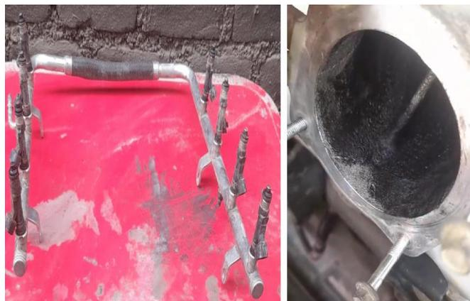
2- Afinamiento electrónico, limpieza en el múltiple de admisión y limpieza cambio de bujías como también termostato.
